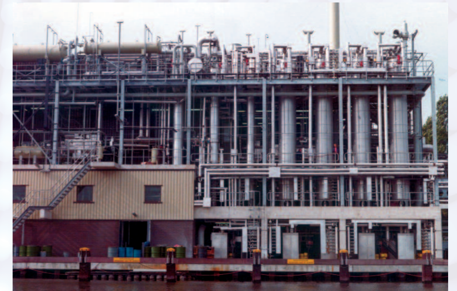
Многоступенчатая выпарная установка пленочного типа для дистилляции мисцеллы
