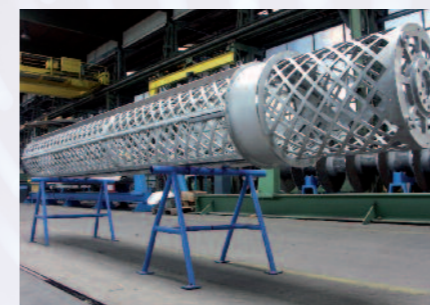
Ротор с центробежными чистящими элементами из тефлона
