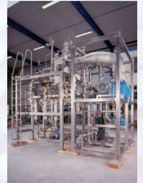
Промышленный модуль с вакуум-выпарным аппаратом
