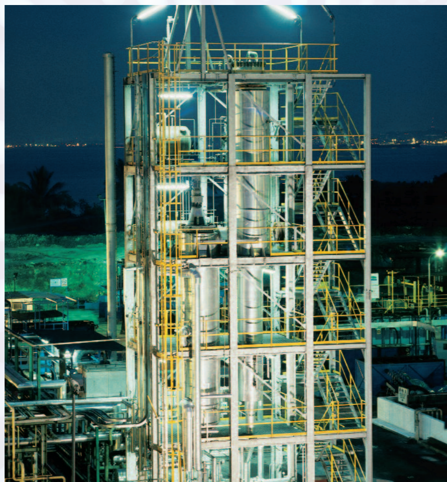
Дегидратация и дистилляция отходов нефтепродуктов (Сингапур)
