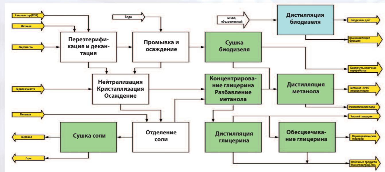
Технологии фирмы Buss-SMS-Canzler, применяемые при производстве биодизеля (зеленые и синие блоки)
