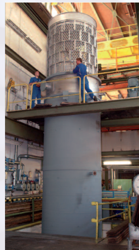
Пленочный испаритель на испытательном стенде
